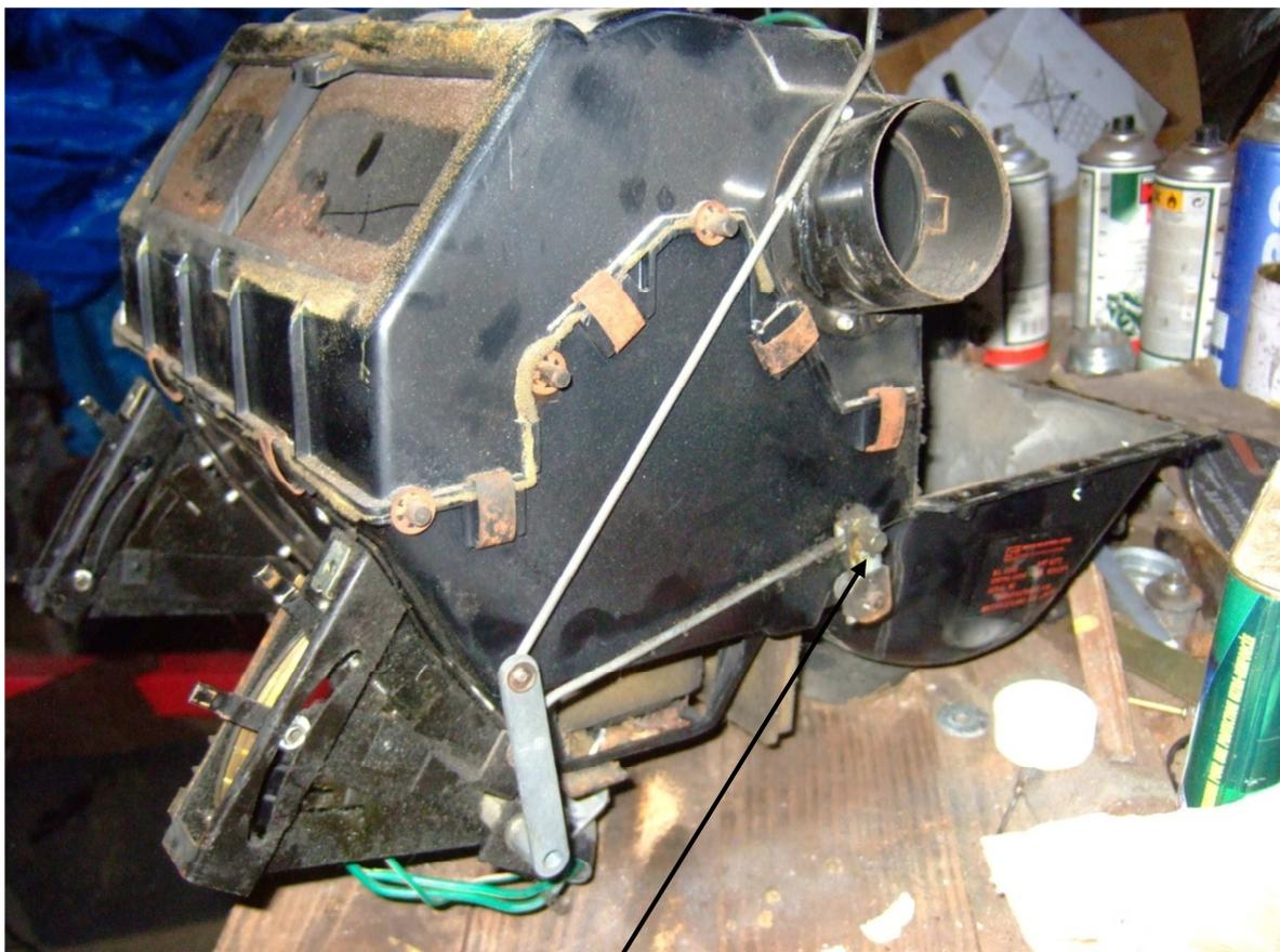
Dévisser les boulons pour dégager les tiges et faite de même pour l'autre côté !
